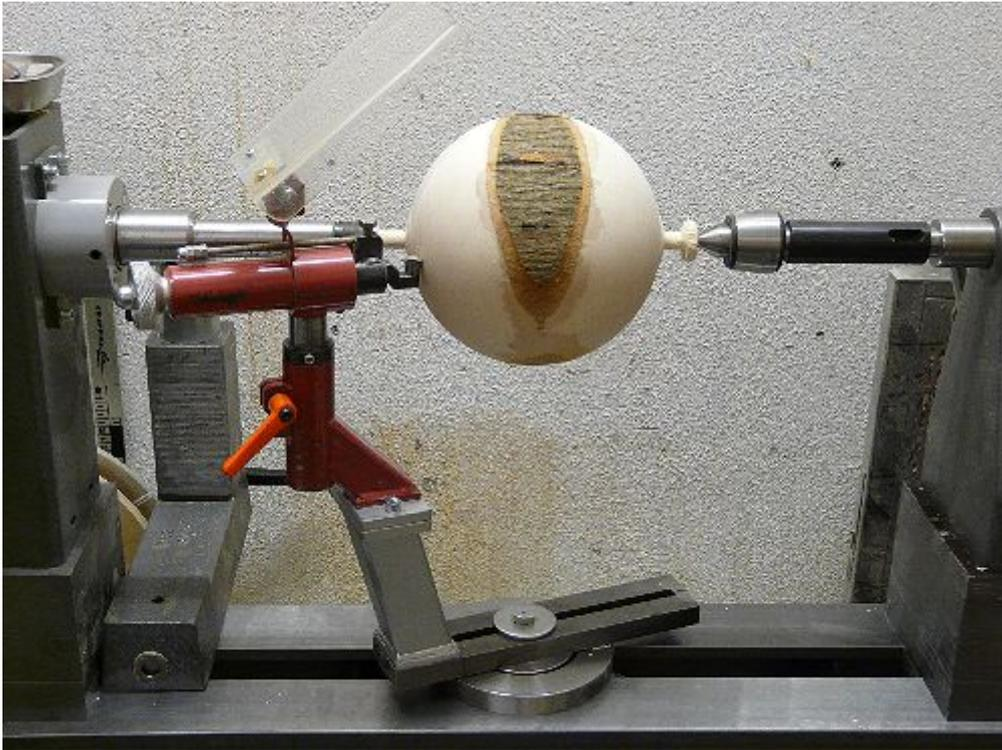
**Modifizierte Kugeldrehvorrichtung mit mittlerem Schwenkarm**
