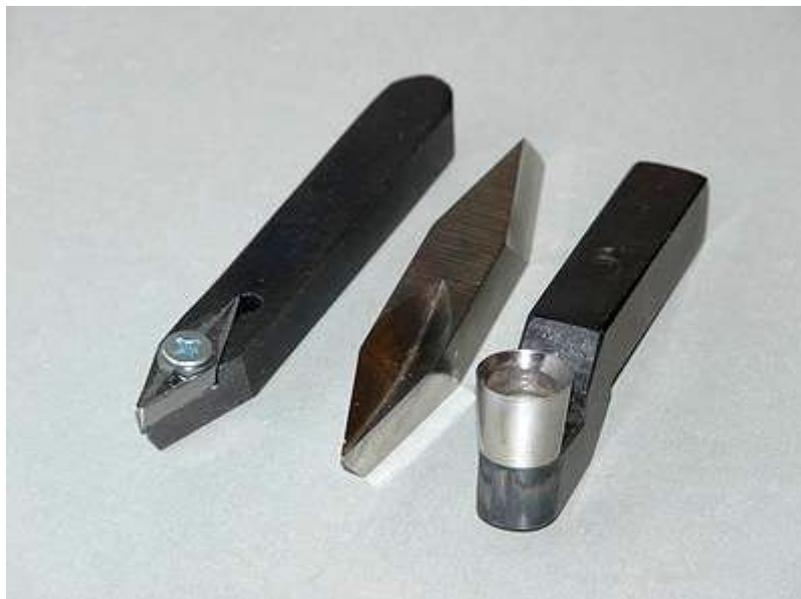
Schneidwerkzeuge für die Kugeldrehvorrichtung. Querschnitt der Aufnahme: 12 x 12 mm
