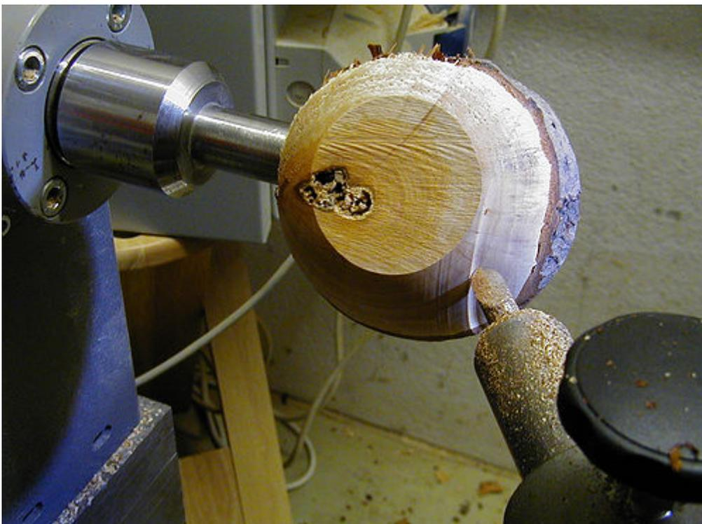
Ein simpler Rundstahl mit 45° Ansliff produziert feine Späne.
