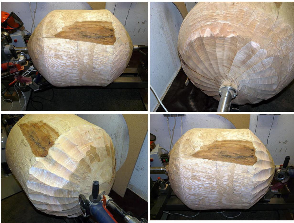
55. Tag: Der Winkelschleifer heulte schon leichte Kugelformen in das Bäumchen. Kleiner Schönheitsfehler: Die auf dem Schwenkarm der Kugeldrehvorrichtung befestigte Maschine ist asymmetrisch montiert. Dadurch bin ich auf der linken Seite bis zu Mitte gekommen, so daß ein Zapfen entstand. Auf der rechten Seite stieß der Winkelschleifer aber mit dem Getriebegehäuse an's Holz. Deshalb konnte ich rechts noch nicht so weit herunter fräsen.
