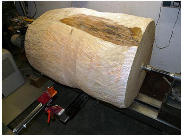
48. Tag: Kugeldrehvorrichtung montiert. Vorher Mittelrille rotogeraspelt, weil dort die Kugeldrehvorrichtung an das Holz stieß. Anschließend dem Baby links und rechts die Speckröllchen weggekaindt. Hoffentlich hält mein Körper durch...
