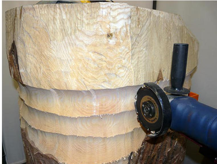
Nach den ersten Stunden fräsen, kann man jetzt ungefähr erkennen, wieviel Arbeit noch auf mich wartet, bis das Ungetüm zum aufspannbaren Rohling geworden ist. Und danach fängt ja erst die Herstellung der Kugel an. Aber der Anfang ist gemacht...
