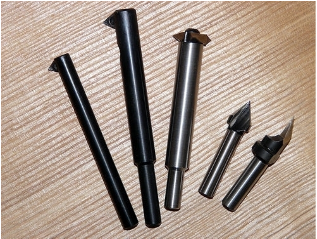
Fräser (60°) zum Gewindefräsen in Holz
