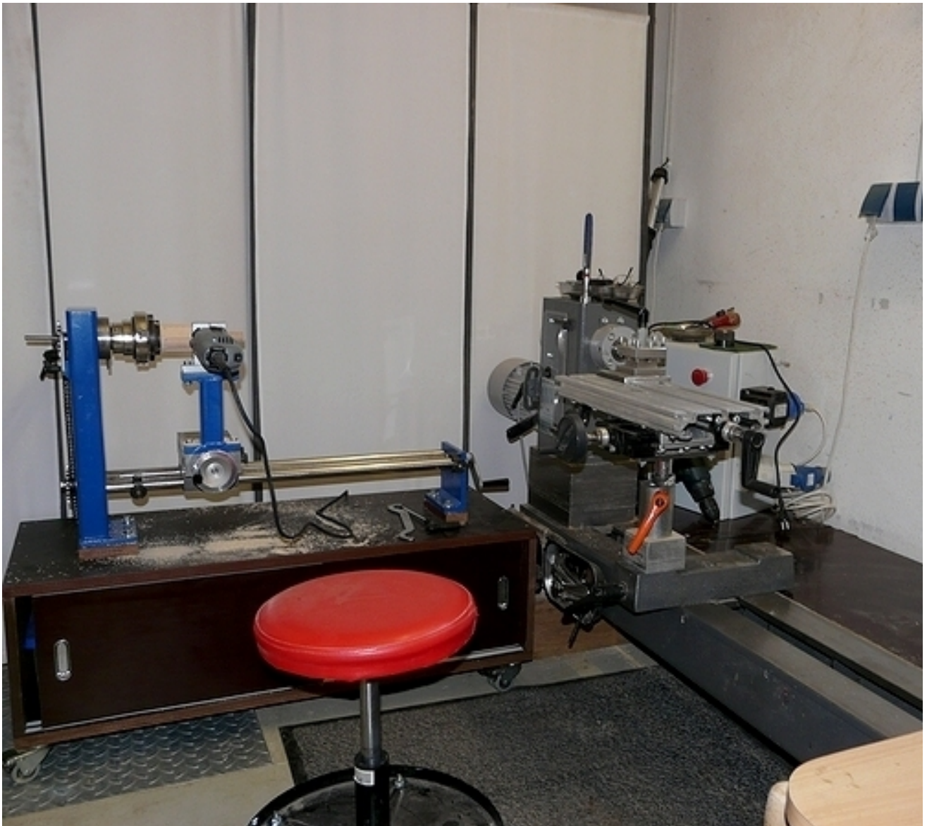
Mögliche Anordnung zum Dreheln und Fräsen.
