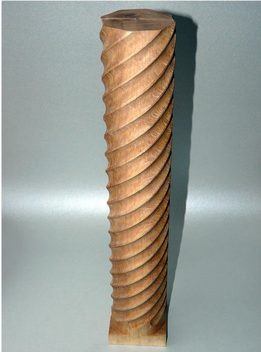
Säule aus verleimter Weissbuche mit acht Rechtswindungen. H: 455 mm D: 80 mm Gewicht: 1,6 Kg
