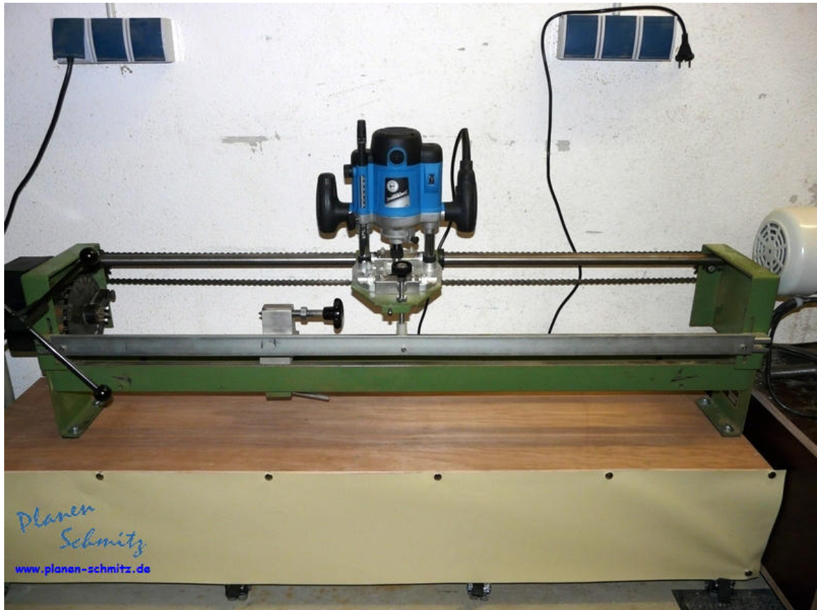
Fräsvorrichtung mit Unterschrank zum Arbeiten im Sitzen. Nach Art des Hauses wieder auf Doppelrollen, vorn feststellbar.
