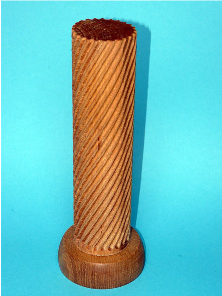
Säule, 24 Windungen mit Spitzfräser 60°. H: 310 mm, D: 70 mm
