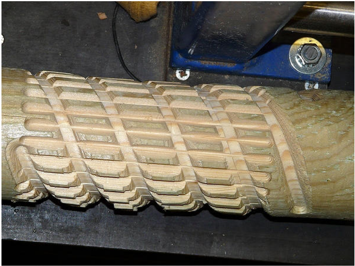
Probestück mit Fräsmotor und Spitzfräser kanneliert.
