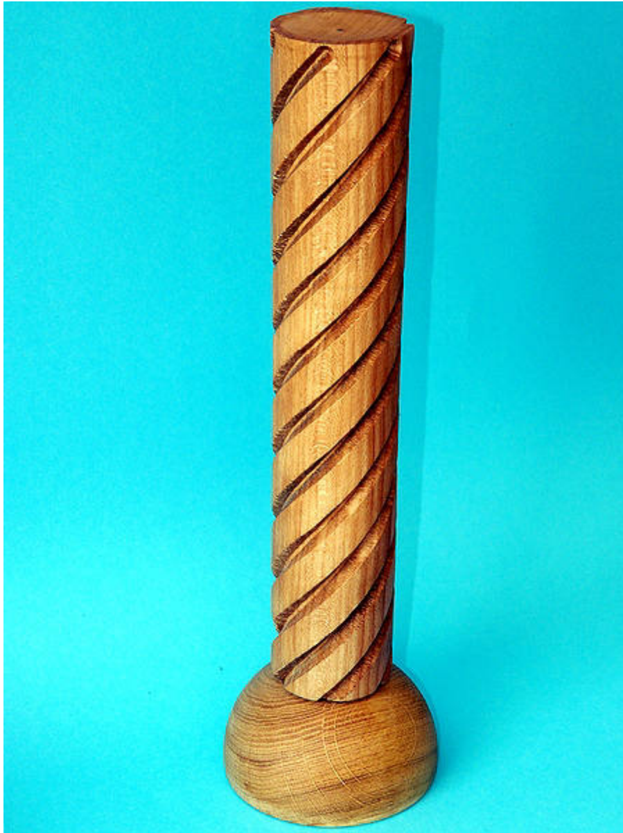
Säule mit sechs Windungen, H: 375 mm, D: 60 mm
